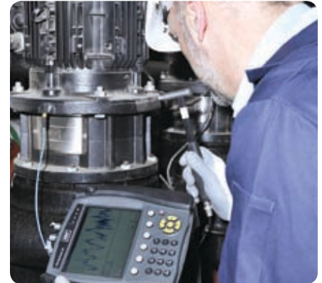
Microlog AX proporciona una rápida recolección y análisis de datos. Su gran pantalla facilita la visualización con cualquier tipo de luz.
